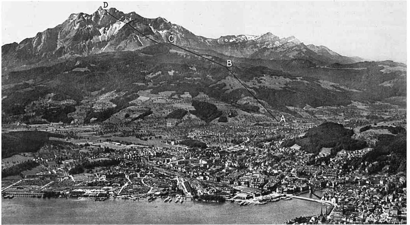
Linienführung der Seilbahnen
